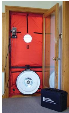
Uitvoeren van een blowerdoortest
