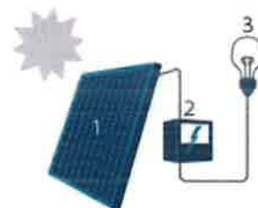
1. Zonnepaneel | 2. Omvormer | 3. Elektrische toestellen
