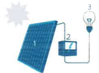
1. Zonnepaneel | 2. Omvormer 3. Elektrische toestellen
