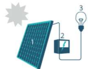
1. Zonnepaneel | 2. Omvormer | 3. Elektrische toestellen
