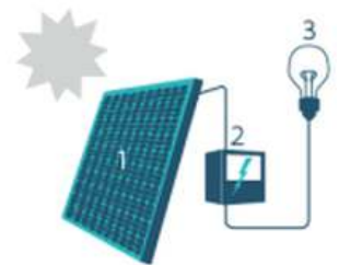
1. Zonnepaneel | 2. Omvormer | 3. Elektrische toestellen
