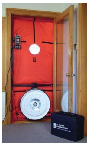
Uitvoeren van een blowerdoortest
