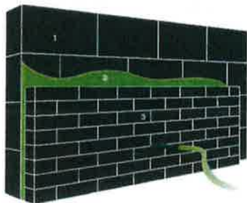
1. Dragende muur | 2. Ingeblazen isolatie | 3. Gevelsteen / gevelbekleding
