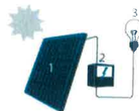
1. Zonnepaneel 2. Omvormer 3. Verbruiker
