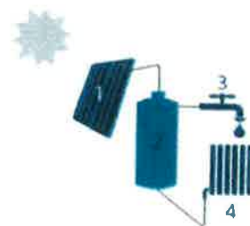
1. Zonnecollector 2. Opslagvat 3. Pomp 4. Verbruiker
