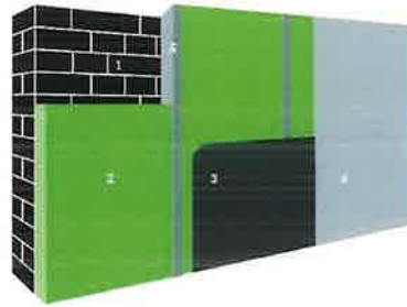
1. Buitengevel | 2. Isolatie | 3. Dampscherf | 4. Binnenafwerking | 5. Stijl- en regelwerk (optioneel)
