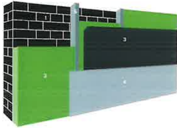
1. Buitenmuur | 2. Isolatie | 3. Vochtscherf | 4. Afwerkingslaag | 5. Stijl- en regelwerk (optioneel)
